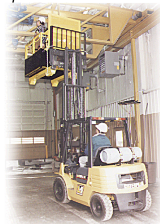
Auf den Gabeln eines Flurförderzeuges angehobene Arbeitsplattform
